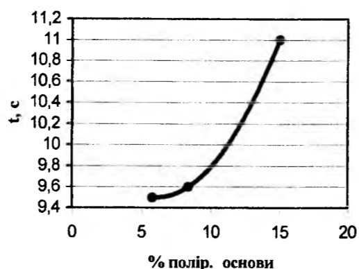
Рис.3. Залежність часу полірування дерев'яної поверхні емульсією від вмісту в ній полірувальної основи.
