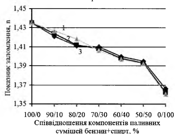
Рис. 6. Залежність показника заломлення паливної суміші від співвідношення бензини і спирту: 1 – 100 %-вий етиловий спирт (мас.); 2 – 96 %-вий спирт (мас.); 3 – 90 %-вий етиловий спирт.
